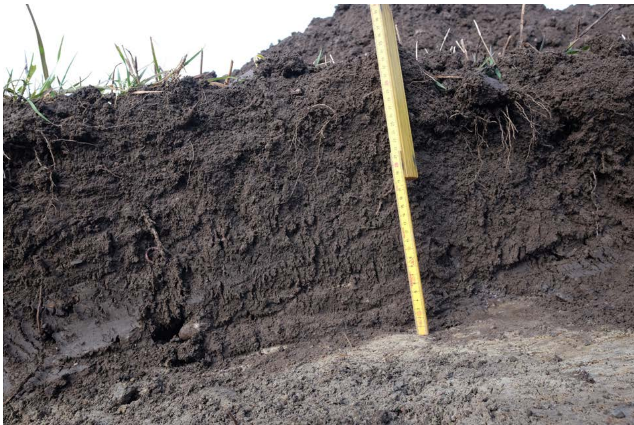
Illustration 23. Profil i schakt 22. Homogent ploglager ovan styv silt. Foto mot väster.
