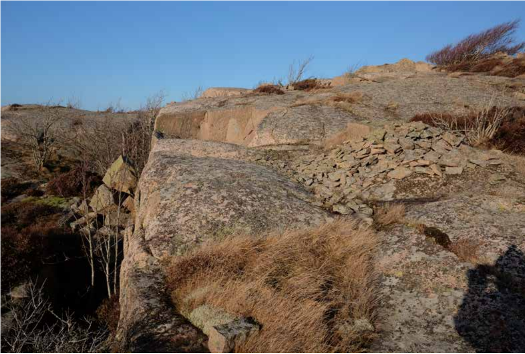
Illustration 1. Litet småbrott i Kungshamn (Sotenäs 4 / Norr om Klippsjön). Här syns bredkilsmärkena i den lilla brottytan, skrotstenen nedanför till vänster, samt arbetsplatsen till höger närmast i bild, med putsskärv, troligen efter tillverkning av gatsten.
