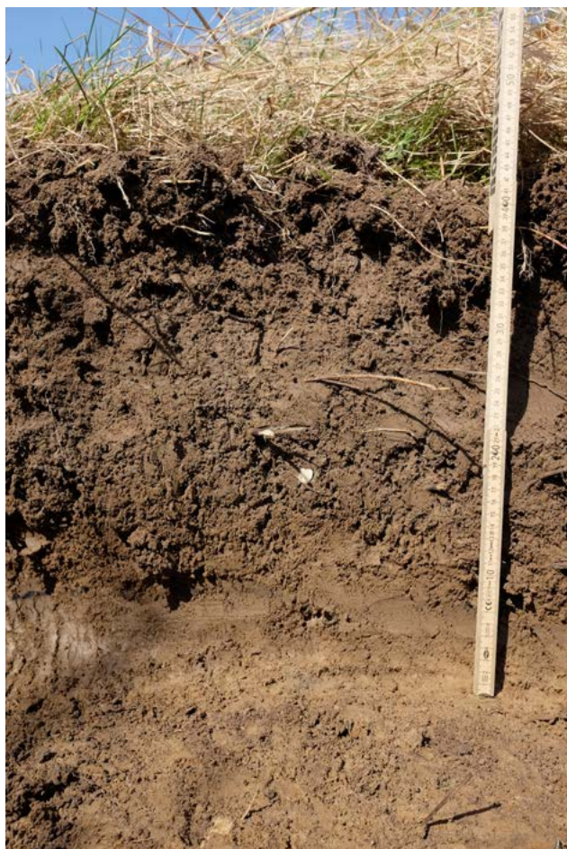
Illustration 4. Profil i schakt 1 med en för platsen typisk lagerföljd av siltig matjord ovan silt eller lerig silt. Foto mot väster.
