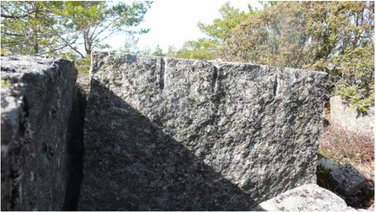
Illustration 13. Märken efter rundkil. Detalj från stenbrott nr 119 inom småindustriområde KUL nr 1701:18. Foto mot norr.
