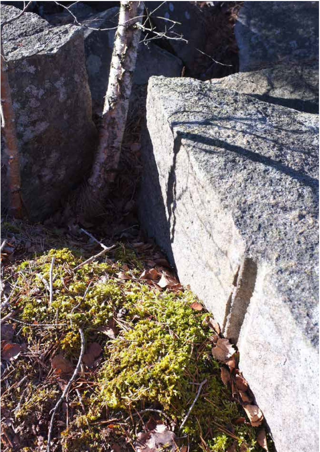
Illustration 14. Märke efter borrh av typen remmare, i stenbrott 115 inom småindustriområdet KUL nr 1701:18. Foto mot sydväst.
