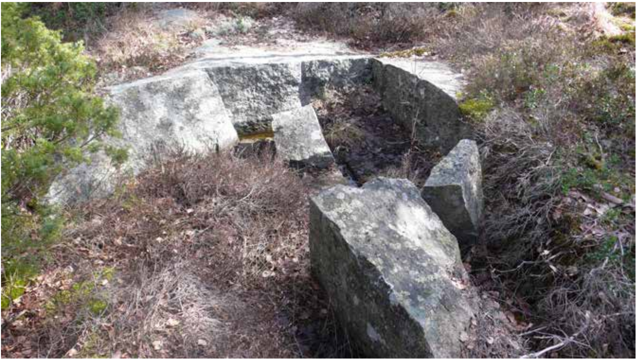
Illustration 11. Litet stenbrott med uttag i en nivå, nummer 135 ingående i småindustriområde KUL nr 1701:17. Märken efter bredkil och ett borrhål kan ses. Foto mot öster.
