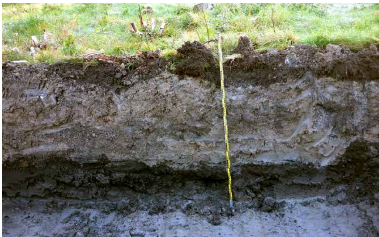
Illustration 16. Schakt 3, profilen visar det cirka 1 meter djupa, påförda, lerlagret som efterföljs av ytterligare 0,55 meter naturligt förekommande lera. Foto mot öst.
